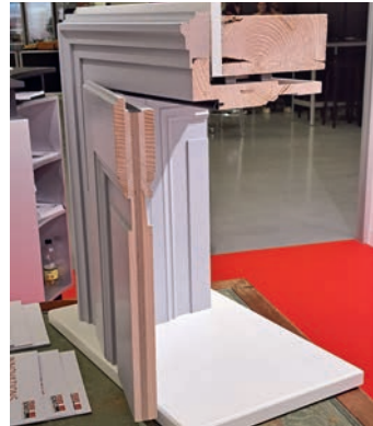
Eine der beiden aufgedoppelten Türblatthälften bei König (links). Brandschutz-türmodell vom FeuerschutzTeam aus einer Originaltür.
