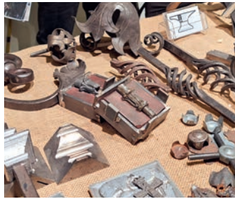
Nachgebildete und technisch angepasste Garnitur von Hedinger mittels 3D-Druck links. Handgeschmiedete Produkte der IG Schmiede rechts.
