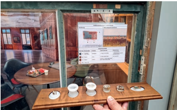
Vor der Restaurierung werden von der Schreinerei Eigenmann die alten Beschichtungen erfasst.
